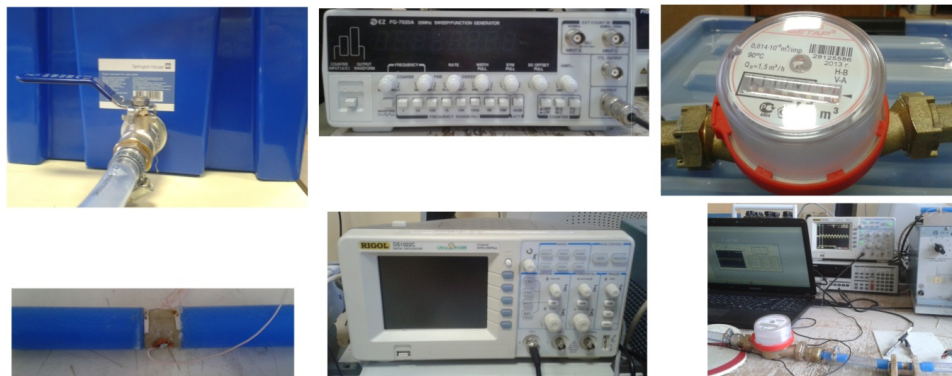
Рис. 8. Фрагменты экспериментальной установки для исследования датчика расхода
