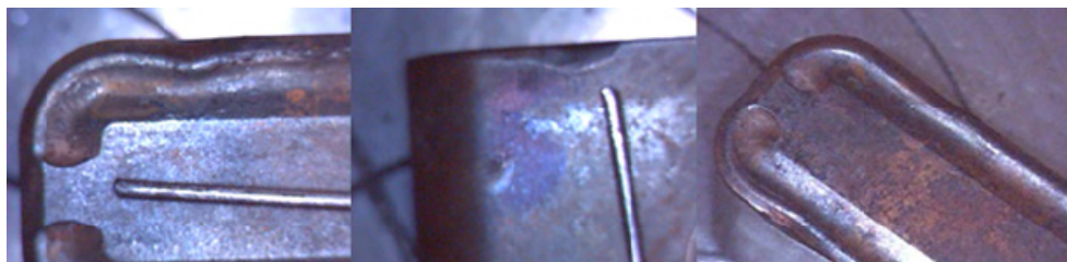
Рис. 1. Кинетика развития очагов изнашивания контактных площадок режущей пластины из твердого сплава AT15S Ti-TiN при обработке катальной поверхности колесной пары с параметрами t = 6,0 мм; S = 1,2 мм; v = 70 м/мин
