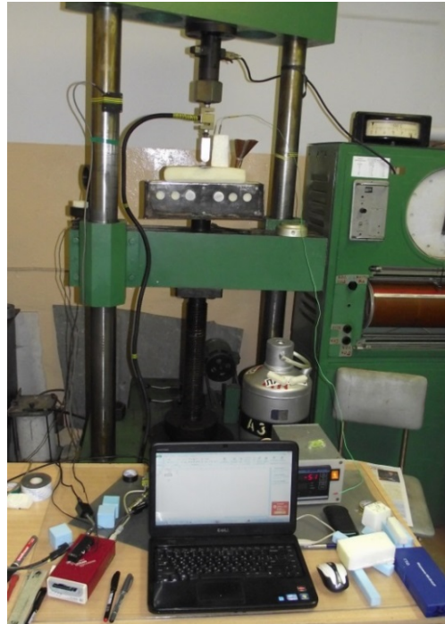
Рис. 1. Фрагмент испытаний на трехточечный изгиб при пониженных температурах
