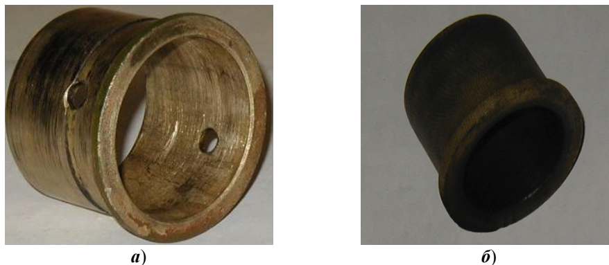
Рис. 12. Втулка 18-131 изделия 2А19: а – латунная; б – из ПКМ
